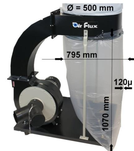
Le Dusty 3000AF aspirateur est équipé d'un sac filtrants en fibre qui retiennent les particules les plus fins de poussière. Optionel, un cartouche filtrante Canister peut être commander pour purifier l'air jusqu'à 0,5µm. Cet aspirateur est alimenté par un moteur à induction de 2CV avec protection en aluminium. Grâce à la base avec roues, l'aspirateur peut être utiliser facilement partout dans l'atelier.
