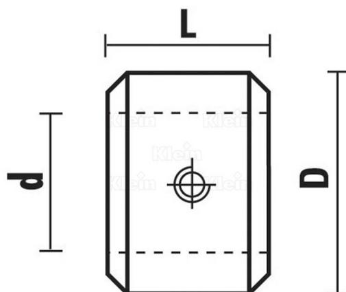
Bagues de limitation de la profondeur de perçage. A utiliser avec les articles suivants : R101 - R201 - R205
