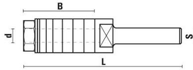
Arbres porte-fraise pour fraises disque C118 de la marque Sistemi Klein. Cette mandrin est approprié pour utilisation avec des fraises disque d'alésage 6mm.. Possibilité à combiner avec roulement nr. Z050 de Sistemi Klein.
