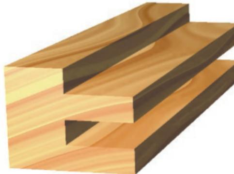
Fraise à rainure Belmash pour machines combinées Belmash et toupies. La fraise à rainures est utilisée pour produire des rainures rectangulaires, pour faire des quartiers et pour couper le long des fibres dans différents types de bois. Il peut être utilisé sur les machines à bois BELMASH SDM2500, SDMR2500, CBS2400 ou sur les fraiseuses à arbre 30mm.
