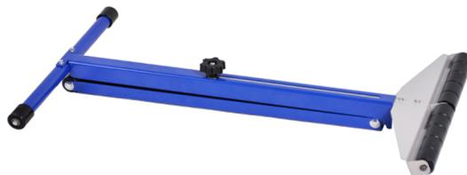
Le Belmash RS-02 est inestimable pour travailler avec des pièces de bois plus longues que ce que la table de travail peut supporter. Ce support à rouleaux offre un moyen sûr et facile de travailler avec ces pièces surdimensionnées. Facile et pratique à utiliser. Equipé de rouleaux en téflon pour éviter d'endommager votre pièce. Hauteur réglable entre 700mm et 1050mm.
