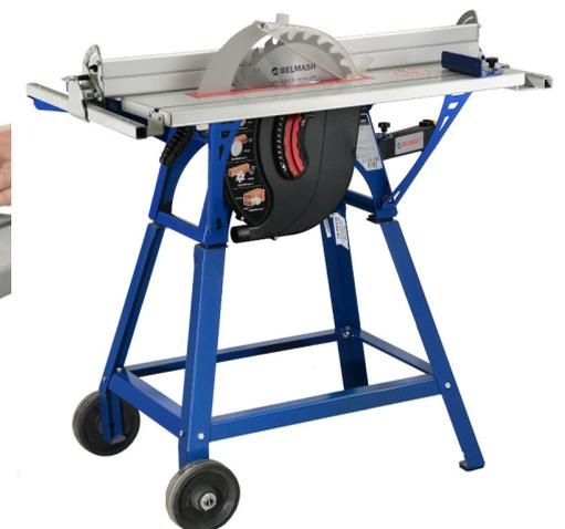
BELMASH SDM-2500 est la machine la plus puissante, la plus fonctionnelle et la plus productive de sa catégorie au monde! Il est possible de scier du bois d'une hauteur de 117 mm, et ce avec une attention à 100% à la sécurité.
