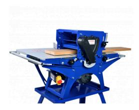
L'unité de rabotage est un outil indispensable pour le rabotage d'épaisseur sur le Belmash SDM2500 et permet d'obtenir une pièce d'excellente qualité. Il possède son propre bloc de coupe qui est entraîné par le moteur du SDM2500. Avec cet appareil, vous pouvez prévoir une épaisseur sur le SDM2500 de 5 à 103 mm et une largeur de rabotage de 250 mm.
