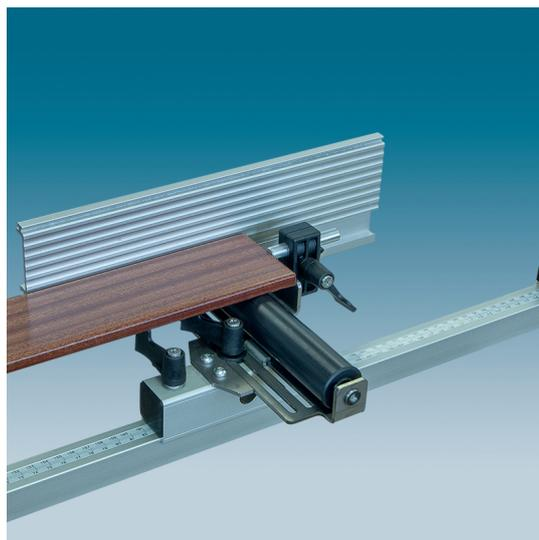
Guide et butée extensibles à utiliser avec la table réglable MT58K de Virutex. Idéal pour couper de longues pièces avec une grande précision et stabilité. Réglage rapide de la longueur par des échelles et des butées graduées en millimètres. Pliable et facile à transporter.
