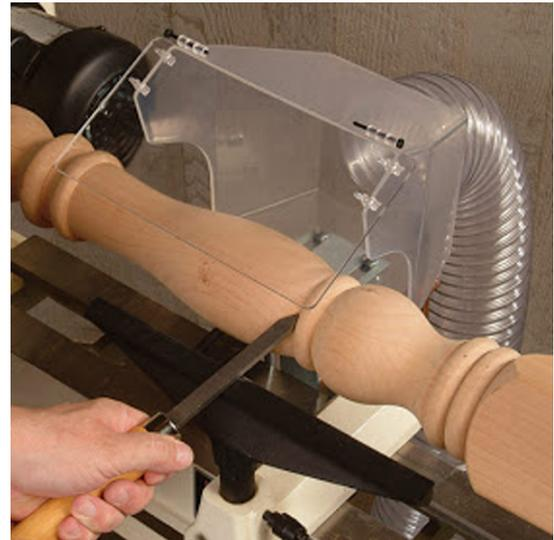
Capot transparent avec tube à diamètre 100mm à utiliser avec les systèmes d'aspiration Air Flux. La taille de l'ouverture du capot anti-poussière est de 200x200mm. Avec couverture.
