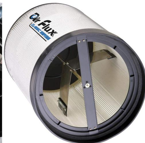
Une mise à jour facile pour améliorer la filtration de votre aspirateur Air Flux 1020AF jusqu'à 30 fois. Le filtre plissé capture la poussière jusqu'à 1µm, contre 30 microns pour le sac filtrant standard et 5 microns pour le sac filtrant amélioré fibre. . Le filtre est autonettoyant grâce au levier situé en haut de la cartouche. Il suffit de tourner la poignée pour enlever la poussière des plis du filtre et elle tombe dans le fond du sac à résidus en PVC fourni.
