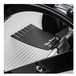
Cartouche filtrante avec filtre à cartouche et sac résiduel pour l'Air Flux Dusty AF-950WM. Le filtre à cartouche capture des poussières aussi petites qu'1 micron, contre 30 microns pour le sac filtrant standard et 5 microns pour le sac filtrant en fibre amélioré. Le filtre est autonettoyant grâce au levier situé en haut de la cartouche. Il suffit de tourner le levier pour retirer la poussière des plis du filtre, qui tombera au fond du sac résiduel en PVC fourni.
