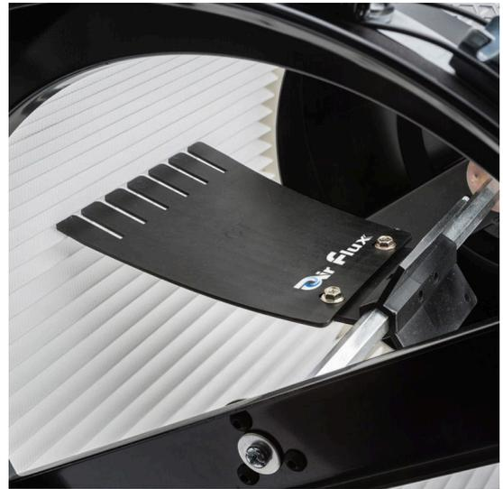
Cartouche filtrante avec filtre à cartouche et sac résiduel pour l'Air Flux Dusty AF-950WM. Le filtre à cartouche capture des poussières aussi petites qu'1 micron, contre 30 microns pour le sac filtrant standard et 5 microns pour le sac filtrant en fibre amélioré. . Le filtre est autonettoyant grâce au levier situé en haut de la cartouche. Il suffit de tourner le levier pour retirer la poussière des plis du filtre, qui tombera au fond du sac résiduel en PVC fourni.
