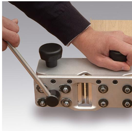
Coupe en bout manuelle pour PVC, mélamine, polyester, placage, etc... avec des couteaux de haute qualité. Le massicot permet une coupe parfaite et nette dans tous les coins de la planche. Grâce aux deux poignées situées en haut, il n'est pas nécessaire de retourner le panneau pour en couper les deux extrémités. Grâce au système de coupe à deux couteaux, une coupe parfaite et nette est toujours garantie. Travail précis jusqu'à un angle ouvert de 120° ou un angle fermé de 45°.
