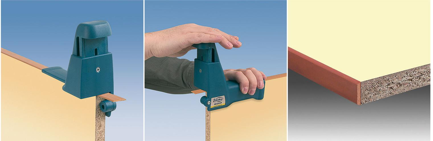
Coupe en bout pour chants manuel pour PVC, mélamine, polyester, placage, etc... jusqu'à une épaisseur maximale de 2 mm. La largeur maximale des bandes de bord de coupe est de 45 mm. Le massicot permet une coupe parfaite et nette dans tous les coins de la planche. Équipé de lames rectifiables et d'un système spécial pour ajuster la position de coupe.
