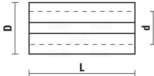
Douille d'augmentation pour des queues de fraises de Sistemi Klein. Utilisez cet adaptateur pour utiliser des fraises de n'importe quel diamètre de queue sur votre machine.
