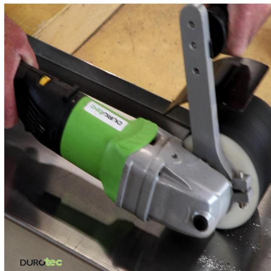
Brosse à polir pour le polissage de l'acier inoxydable, du métal, de la laque, etc. La structure en lamelles empêche le feutre de brûler. Cette brosse permet d'obtenir des résultats de polissage de haute qualité sans laisser de traces.
