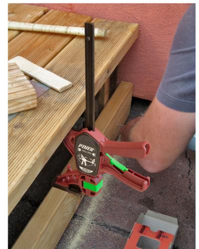
Serre-joint très pratique qui peut être utilisée d'une seule main. Têtes en nylon et fibre de verre réversibles par un système de clic.
