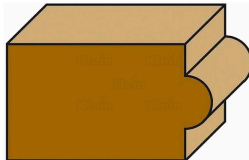
Les fraises à rayon à nez de taureau sont idéales pour façonner des bords entièrement arrondis ou des profils demi-ronds sur les appuis de fenêtre, les bords de table et de comptoir, les étagères et pour fabriquer des moulures. Vous pouvez également fabriquer des goujons en deux passes. Grâce à ses tranchants en carbure de haute qualité (widia), cette fraise peut être utilisée sur la plupart des types de bois. Passez plusieurs fois lorsque vous enlevez de grandes quantités de matière.
