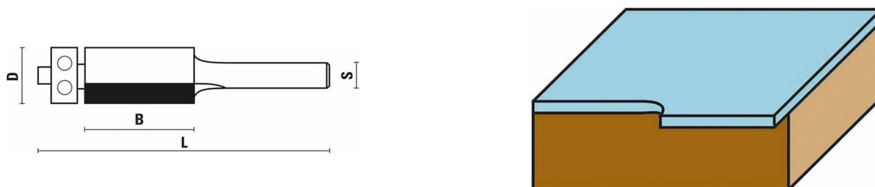
Les fraises Klein® à coupe droite conviennent aux chants lisses et bien finis des panneaux de mélamine et de placage. Le roulement, ayant le même diamètre que les fraises, coupe tout chevauchement en laissant un bord plat et lisse. Deux faces de coupe assurent une coupe rapide et une bonne éjection des copeaux. Les lames sont spécialement cisailées pour que vous puissiez travailler plus rapidement et sans éclats.
