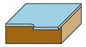
Les fraises Klein® à coupe droite conviennent aux chants lisses et bien finis des panneaux de mélamine et de placage. Le roulement, ayant le même diamètre que les fraises, coupe tout chevauchement en laissant un bord plat et lisse. Deux faces de coupe assurent une coupe rapide et une bonne éjection des copeaux.
