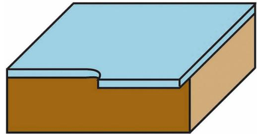
Les fraises Klein® à coupe droite conviennent aux chants lisses et bien finis des panneaux de mélamine et de placage. Le roulement, ayant le même diamètre que les fraises, coupe tout chevauchement en laissant un bord plat et lisse. Deux faces de coupe assurent une coupe rapide et une bonne éjection des copeaux.
