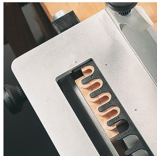
Cette fraise à coupe droite est adaptée à la réalisation de rainures droites pour les assemblages à queues droites. Utilisez ce type de jonction pour faire des tiroirs, armoires ou des autres types de meuble. Grâce au deux faces à couper en HW (carbide) une finition précise et propre est toujours garantis.
