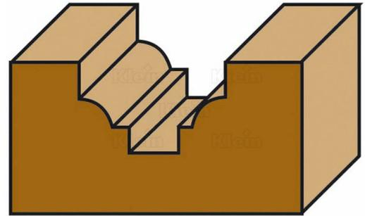
Fraise à double rayon classique pour réaliser de belles arêtes nettes sur des armoires, des portes, des tiroirs ou d'autres meubles. Grâce à ses tranchants en carbure de haute qualité (widia), cette fraise peut être utilisée sur la plupart des types de bois.
