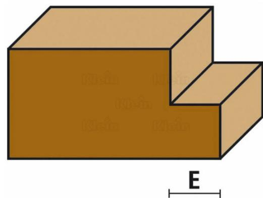
Utilisé pour faire des remises ou des rabais sur les meubles, les portes, les tables et les tiroirs. La fraise produit des coupes douces et correctes sur les deux surfaces. Ces fraises sont fournis de faces de coupe en carbide. Grâce à ces arêtes de coupe en carbide, la fraise coupe sans effort la plupart des types de bois. Vous obtenez un résultat parfait pour tous vos projets et une longue durée de vie.
