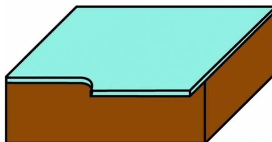
Cettes fraises à coupe droite conviennent aux bords lisses et bien finis des panneaux stratifiés et plaqués. Le roulement, ayant le même diamètre que les fraises, coupe tout chevauchement en laissant un bord plat et lisse. Grâce à ses tranchants en carbure de haute qualité (widia), cette fraise peut être utilisée sur la plupart des types de bois.
