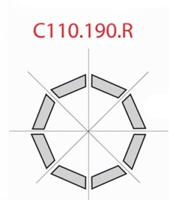
Ces fraises à rainurer en V vous permettent de réaliser des rainures en V profondes et peu profondes, idéales pour la fabrication d'enseignes ou d'éléments décoratifs sur des panneaux ou des meubles. Utilisez cette fraise sans risque de brûlures. La fraise est également très adaptée à la réalisation de chamfreins. Il est recommandé de passer plusieurs fois lors de l'enlèvement de grandes quantités de matériel.
