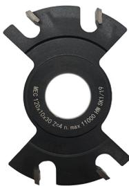
Fraise à rainurer réglable à lames fixes en carbure (widia) pour réaliser de fines rainures de précision. Réglable en hauteur entre 5 mm et 9,5 mm au moyen de bagues. Bagues disponibles séparément. Grâce aux lames en carbure de tungstène, cette fraise à rainurer coupe sans effort les planches massives, les bois durs et tendres, le MDF ou les planches laminées.
