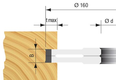
Fraise à rainurer à lames réversibles et précouteaux en carbure de haute qualité (HW) pour la réalisation de fines rainures de précision. Réglable en hauteur entre 8 mm et 15 mm au moyen de bagues d'écartement. Bagues incluses en standard. Grâce aux lames en carbure de tungstène, cette fraise à rainurer coupe sans effort les planches massives, les bois durs et tendres, le MDF ou les planches laminées.
