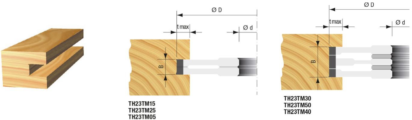
Fraise à rainurer à lames réversibles et précouteaux en carbure de haute qualité (HW) pour la réalisation de fines rainures de précision. Réglable en hauteur entre 4 mm et 7,5 mm au moyen de bagues d'écartement. Bagues incluses en standard. Grâce aux lames en carbure de tungstène, cette fraise à rainurer coupe sans effort les planches massives, les bois durs et tendres, le MDF ou les planches laminées.
