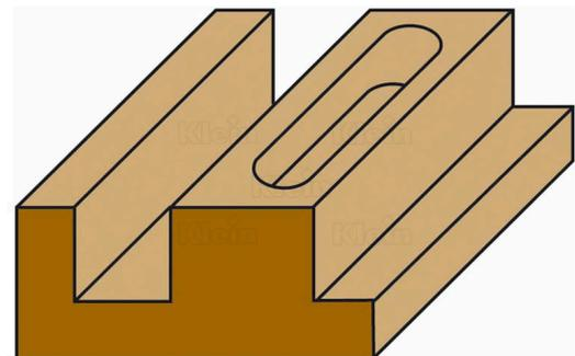
Fraises à rainurer sont spécifiquement conçue pour faire des rainures dans des types de bois différents ou des plastiques. Grâce au face de coupe supplémentaire en bout de fraise (Z=2+1), c'est aussi possible de facilement faire de perçage. Le fraise est réalisé complètement en métal dure (carbide) et a une finition spéciale 'micrograin' pour des prestations améliorés. Grâce à tous ces qualités, le fraise vous assure un résultat parfait de tous votre projets ét une longue durée de vie.
