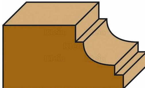
La fraise à rayon convexe de Sistemi Klein est parfaite pour usiner les bords des armoires, des portes et des tiroirs ou des colonnes. À l'aide de cette fraise, créez des rainures en quart de rond avec des bords droits sur la plupart des types de bois.
