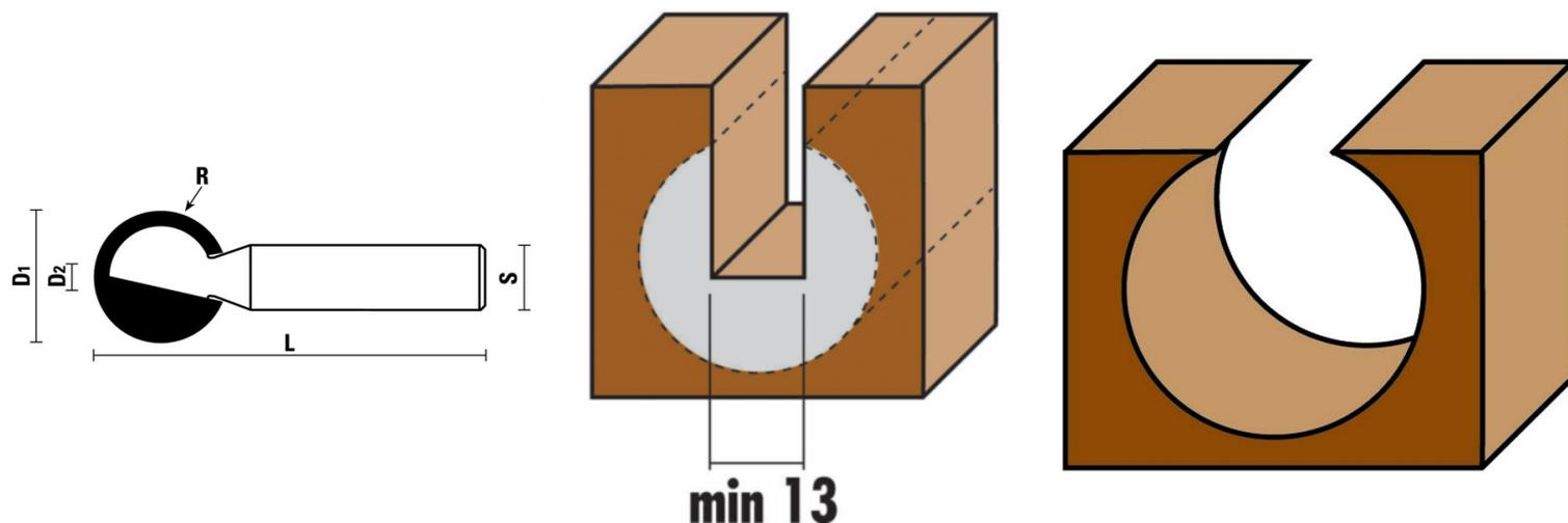
À l'aide de cette fraise boule, vous pouvez rapidement et facilement faire des rainures pour les panneaux coulissants ou le câblage électrique. Grâce à ses tranchants en carbure de haute qualité (widia), cette fraise peut être utilisée sur la plupart des types de bois. Utilisez une fraise droite pour faire une rainure première afin que la queue de la fraise puisse se déplacer librement.
