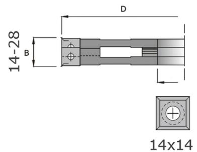
Fraise à rainurer à lames fixes et précouteaux en carbure de haute qualité (HW) pour réaliser des rainures de précision. Réglable en hauteur entre 14mm et 28mm au moyen de bagues d'écartement. Bagues disponibles séparément. Utilisez également cette fraise pour réaliser des tenons ou des rabais. Grâce aux lames en carbure de tungstène, cette fraise à rainurer coupe sans effort les planches massives, les bois durs et tendres, le MDF ou les planches laminées. Equipé de lames dimensions 14x14mm.
