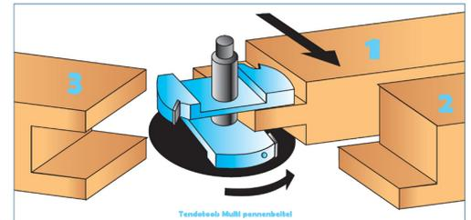
Fraise à rainurer à lames fixes et précouteaux en carbure de haute qualité (HW) pour réaliser des rainures de précision. Réglable en hauteur entre 20mm et 39mm au moyen de bagues d'écartement. Bagues disponibles séparément. Utilisez également cette fraise pour réaliser des tenons ou des rabais. Grâce aux lames en carbure de tungstène, cette fraise à rainurer coupe sans effort les planches massives, les bois durs et tendres, le MDF ou les planches laminées. Equipé de lames dimensions 20x12mm.
