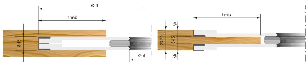
Fraise à rainurer à lames réversibles et précouteaux en carbure de haute qualité (HW) pour réaliser des rainures de précision. Réglable en hauteur entre 8 mm et 15 mm au moyen de bagues d'écartement. Bagues incluses en standard. Utilisez également cette fraise pour réaliser des tenons ou des rabais. Grâce aux lames en carbure de tungstène, cette fraise à rainurer coupe sans effort les planches massives, les bois durs et tendres, le MDF ou les planches laminées.
