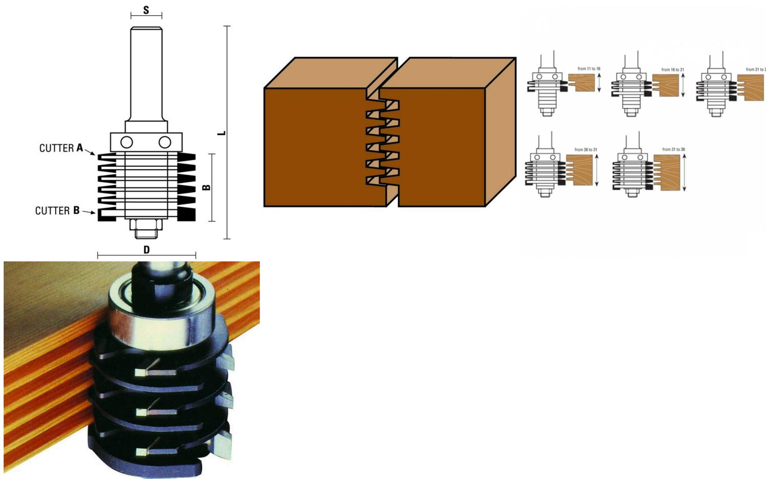
Cette fraise pour joints collés est composé de six disques différents. Par conséquent, la plus petite longueur de coupe est de 11 mm (avec un disque de coupe) et la longueur de coupe maximale est de 36 mm (avec tous les disques de coupe). En fonction de l'épaisseur de votre projet, choisissez la bonne composition pour la fraise.
