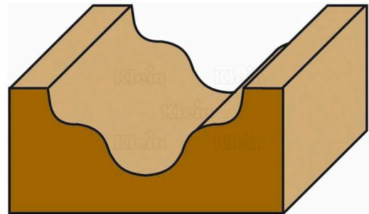
Fraise à double rayon classique pour réaliser de belles arêtes nettes sur des armoires, des portes, des tiroirs ou d'autres meubles. Grâce à ses tranchants en carbure de haute qualité (widia), cette fraise peut être utilisée sur la plupart des types de bois.
