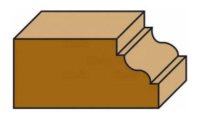
Fraise à double rayon classique pour réaliser de belles moulures sur des armoires, des portes, des tiroirs ou d'autres meubles. Grâce à ses tranchants en carbure de haute qualité (widia), cette fraise peut être utilisée sur la plupart des types de bois.
