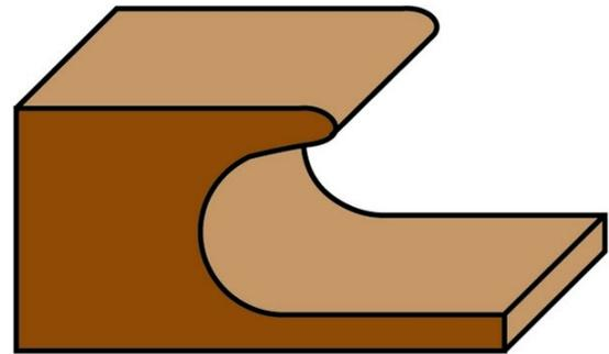
Cettes fraises permettent de réaliser des poignées intégrées dans les tiroirs ou les portes. Grâce à l'arrondi de la fraise, vous obtenez une bonne prise en main de votre poignée et il n'y a pas de bords tranchants. Cette fraise de Sistemi Klein est parfait pour ceux qui veulent faire leurs propres portes de placard ou tiroirs. Comme la fraise enlève de grandes quantités de matériaux pendant le travail, il est recommandé de garder les mains aussi loin que possible de la fraise en marche.
