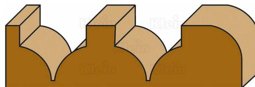
Cette fraise à rayon creux permet d'arrondir facilement et rapidement les coins pour obtenir une forme ronde.
