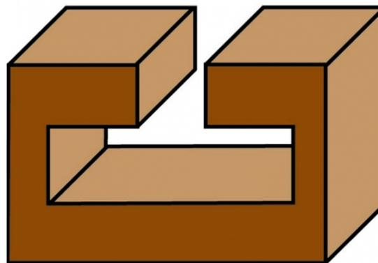
Cette fraise est spécialement conçue pour créer des rainures en T dans la plupart des types de bois. Ceux-ci peuvent être utilisés, entre autres, pour insérer des profils alu. Le face de coupe en carbure de haute qualité (widia) vous garantit une finition parfaite pour tous vos projets.
