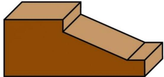
Cette fraise à rainurer horizontale est parfaite pour la fabrication de portes d'armoires ou d'autres meubles. La fraise a un grand diamètre mais grâce à un équilibre parfait, elle fonctionnera toujours sans problème de vibration.
