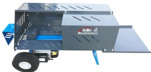
Cette fendeuse à bois horizontale et compacte est parfaite pour un usage domestique et pour fendre le bois de chauffage. Avec cette machine, vous fendez sans effort des pièces de bois jusqu'à 520 mm de longueur et 300
