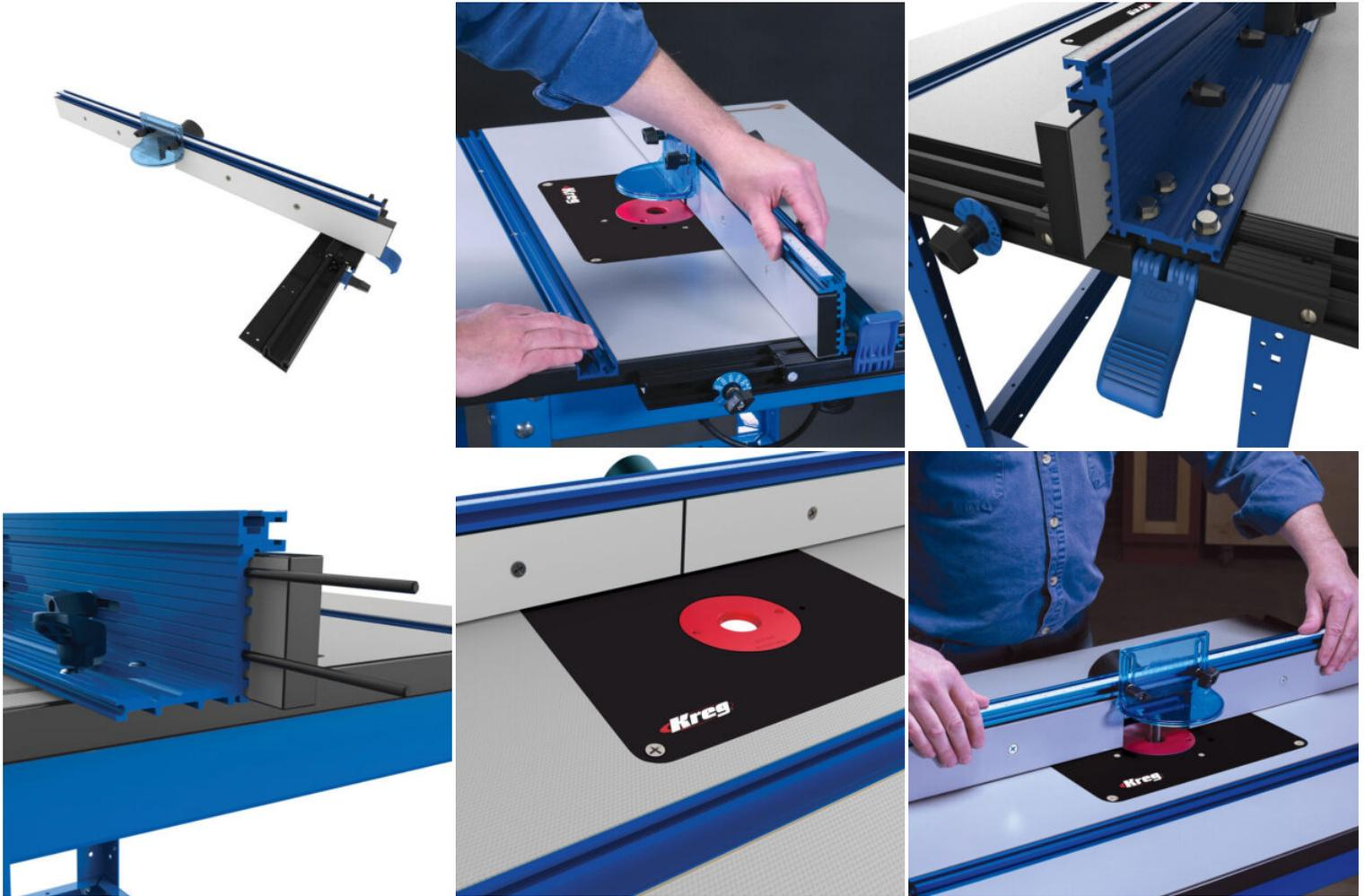
Ce rail de guidage en aluminium anodisé est équipé d'un système de réglage en T qui maintient le rail toujours parallèle à la rainure de la jauge d'onglet. Le rail de guidage est facile à régler et est maintenu fermement en place par un double mécanisme de verrouillage, à savoir un levier du côté de l'entrée et un bouton quart de tour du côté de la sortie, de sorte que le rail ne se plie pas.
