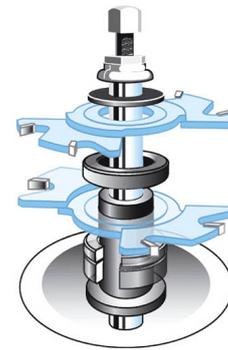
Jeu de six bagues de remplissage en haute qualité avec un tolérance de 0,01. Produit par le procédé de fineblanking. Tous les bagues ont un alésage de 50mm et un diamètre de 70mm. Les épaisseurs varient entre 2 mm et 30 mm.
