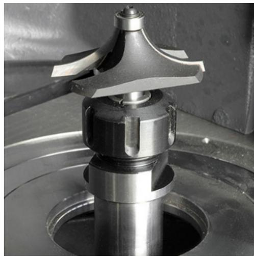
Ce jeu vous offre une solution prête à l'emploi pour placer des fraises de défonceuse queue Ø8mm, Ø10mm ou Ø12mm sur l'arbre de votre toupie. Grâce à l'arbre M14, il est facile et rapide de monter le mandrin à pince sur la broche de votre fraiseuse. Combinez avec l'une des trois pinces de serrage pour obtenir le diamètre correct pour votre fraise de défonceuse.
