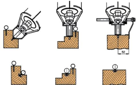
Joint isolant en silicone pour fenêtres et portes de couleur marron. Excellente résistance à des températures comprises entre -60 et 200°C. Avec ce sceau, vous bénéficierez à la fois d'une bonne isolation température et d'une bonne isolation acoustique. Essentiel pour les nouvelles constructions et facile à intégrer dans les constructions existantes. Utilisez la rainureuse Virutex RA17VG avec le mèche ancre double.
