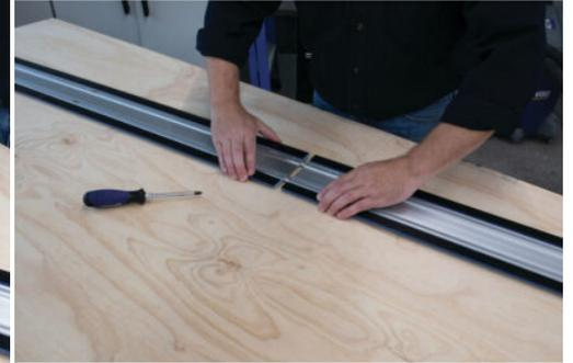
Coupez deux fois plus long avec le kit d'extension Accu-Cut™. Il se fixe facilement à l'Accu-Cut™ pour réaliser des coupes également droites, précises et sans éclats jusqu'à 2540 mm de longueur.
