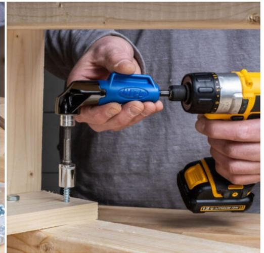
Transformez n'importe quelle perceuse en perceuse à 90° avec le tournevis pour trous de poche à 90° de Kreg. Avec cet accessoire compact pour perceuse, vous pouvez serrer des vis dans des endroits où vous ne pouvez pas les atteindre avec votre perceuse.
