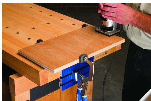
Jeu de 4 crochets d'établi en nylon (dits 'bench dogs') de Kreg avec capuchons antidérapants en caoutchouc. Convient à tous les établis avec des trous de Ø 19 mm. Les 'dogs' peuvent être utilisés aussi bien horizontalement que verticalement.
